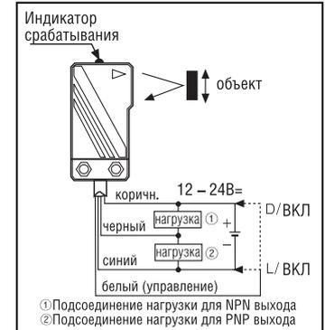
※ Когда линия управления разомкнута, включается режим реагирования на затемнение
