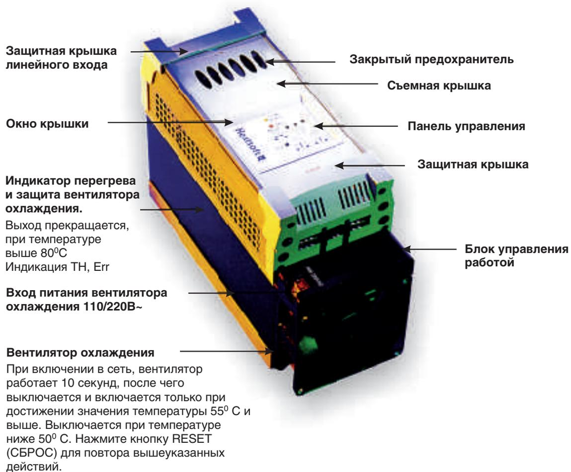
**Примечание:** Крышку можно поднять, путем нажатия защитной крышки вниз. Для подключения проводов и смены предохранителя, при необходимости, крышку можно открыть нажатием и последующим снятием.
