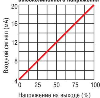
Выходное напряжение (B) = Выходное напряжение % X CT, ADJ%
