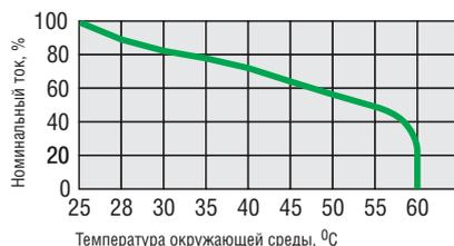
\* Значения, приведенные выше основываются на данных, полученных при правильных условиях эксплуатации радиатора (отсутствие коррозии и масляного загрязнения; правильная установка для конвекции тепла).
