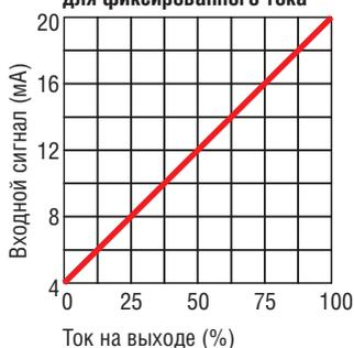
Ток на выходе (A) = Ток на выходе % X CT, ADJ% X Heatsoft - V номинальный ток
