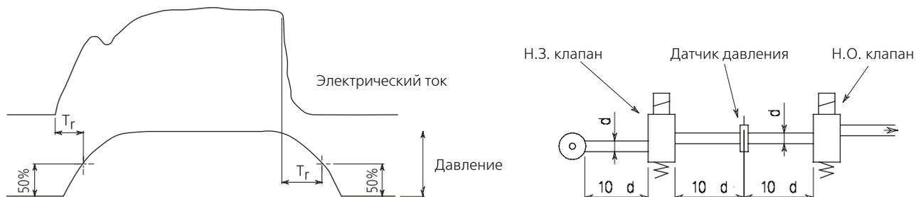
Время переключения клапана  $T_r$  зависит от типа клапана, вида рабочего тела (жидкость, газ), давления потока и его вязкости, рода электрического тока (постоянный или переменный).
