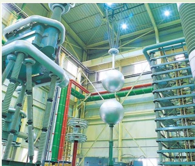
Высоковольтные испытания | Тест импульса
