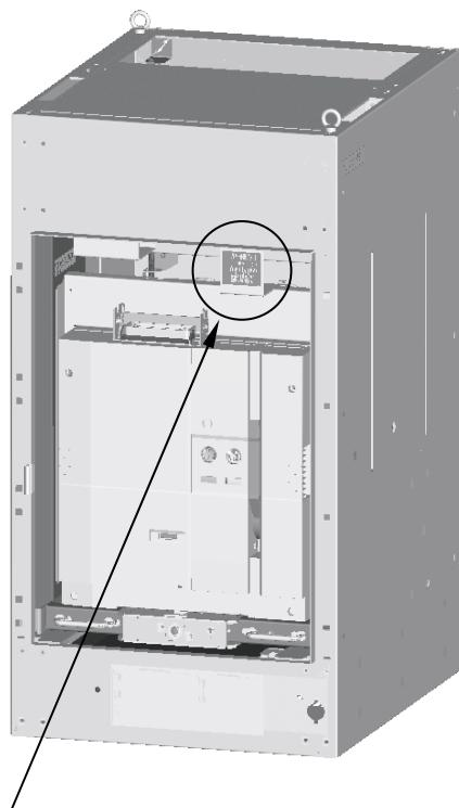
\*Скоба для фиксации автоматического выключателя
